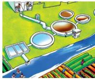
**AIREACIÓN**, aquí se procura que el agua pase por dispositivos que la atomizan, con ello se logra la eliminación de olores desagradables y le da un sabor más agradable.
